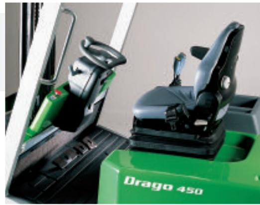
**B**ewegungsfreiheit und Präzision. Der komfortable und geräumige Fahrerraum erlaubt während der Manövriervorgänge eine großzügige Sicht vom Fahrersitz aus. Die verschiedenen zur Verfügung stehenden Fahrrichtungsumschaltungen (Hand- und zwei Versionen der Fußumschaltung) lassen keine Wünsche offen.
