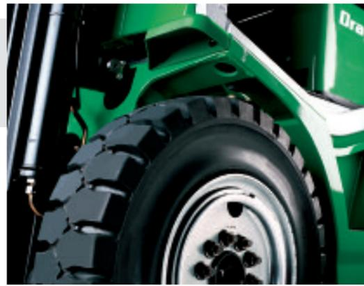
**G**roße Vorderräder garantieren hohe Standsicherheit und Fahrkomfort auch auf unebenen Oberflächen. Die kompakte, stossgesicherte Lenkachse steigert die positiven Fahreigenschaften.
