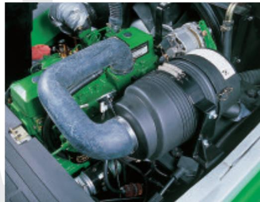
**D**er starke und zuverlässige Motor John Deere ermöglicht ein hohes maximales Drehmoment bei sehr niedriger Drehzahl. Dank dieser Leistungen hat der Stapler ein weniger Vibrationsniveau und niedriger Geräuschpegel.
