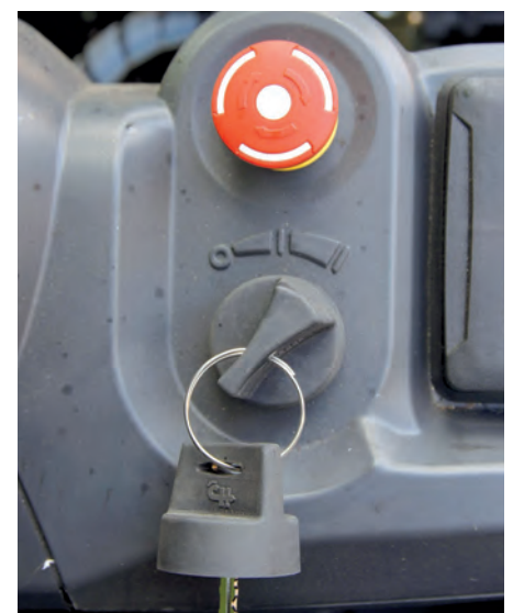
06 Über zwei Schlüsselpositionen kann der Fahrer zwischen dem sparsamen Eco- und dem leistungsorientierten Pro-Modus wählen
