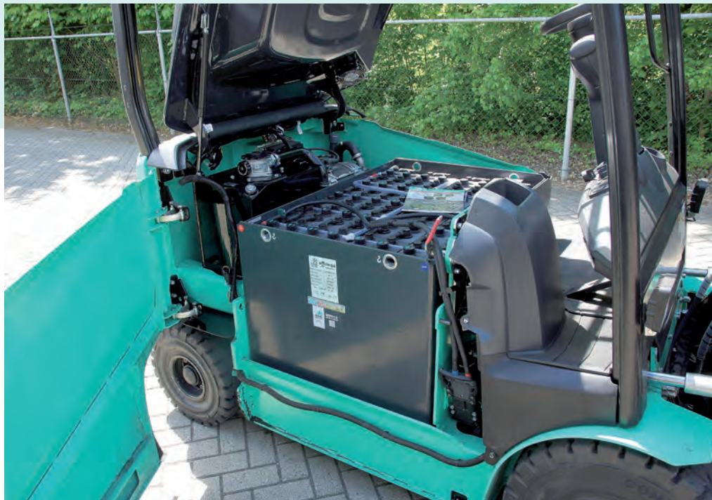
01 Der Stapler Edia EX FB25CN verfügt zum Wechseln der Batterie über eine große Seitentür
