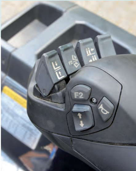
04 In die Armlehne integriert sind Minihebel für die Mastfunktionen
