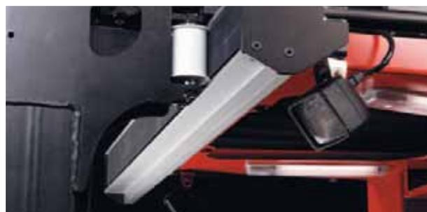
Aluminium-Bauteile im Schwenkschubgabelaggregat senken das Gewicht – das Ergebnis: weniger Energieverbrauch und kürzere Hubzeiten
