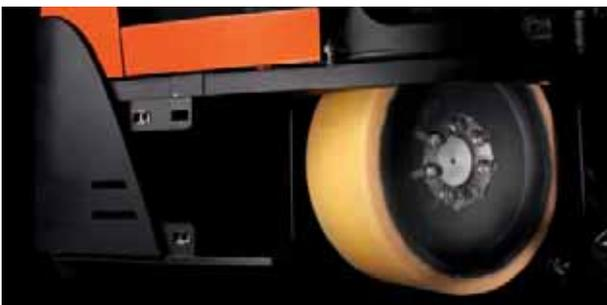
*Das deutlich vergrößerte Antriebsrad der BT Vector R-Serie bietet einen besseren Fahrkomfort, während gleichzeitig der Verschleiß sinkt*
