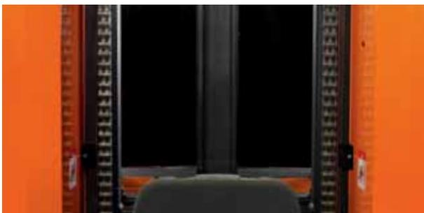
*Das Hubgerüst gewährt freie Sicht – für einfacheres, sichereres Rückwärtsfahren*
