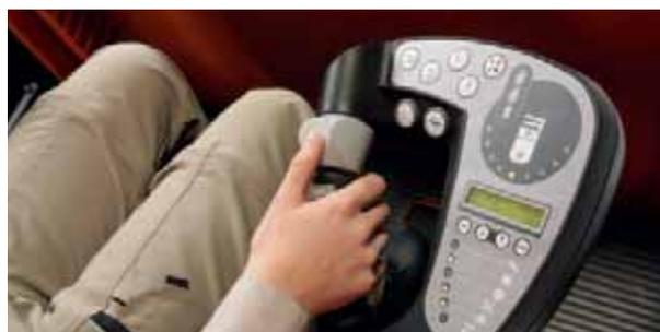
Alle Fahrzeugbewegungen werden über Tiptasten gesteuert – einfach, reaktionsschnell und ohne Kraftaufwand. Dies ermöglicht ein schnelles, präzises Arbeiten
