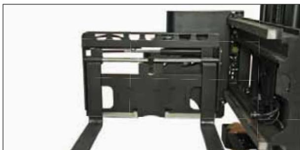
*Mit der optionalen Schwenkautomatik kann der Fahrer den Schwenkschub mit einem einzigen Hebel steuern. Der Bewegungsablauf wird automatisch auf möglichst geringen Platzbedarf optimiert*
