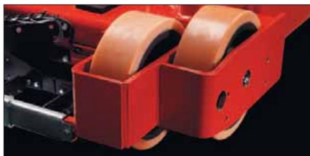
*Die versetzten Vorderräder des VCE150A steigern die Stabilität und reduzieren die Bodenbelastung*
