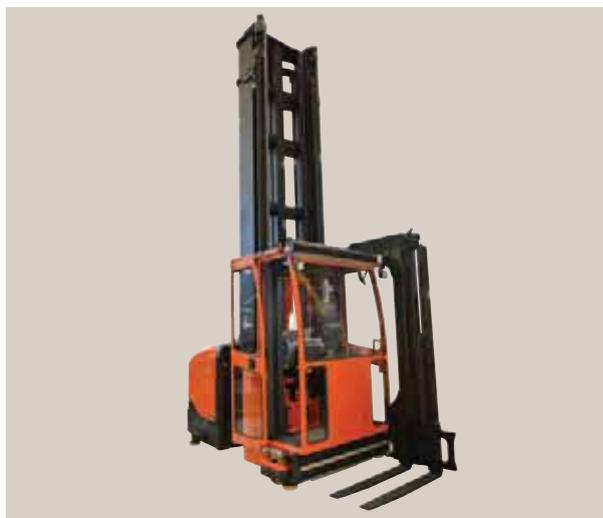
VCE150A mit komplett geschlossener Fahrerkabine für den Einsatz im Kühlhaus
