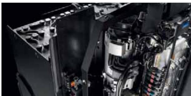
Die AC-Motoren zeichnen sich durch niedrigeren Wartungsaufwand und eine geringere Anzahl von Bauteilen aus
