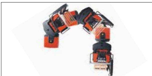
Das Knickgelenk-Chassis der BT Vector A-Serie ermöglicht bis zu einen Meter schmalere Umsetzgänge als bei herkömmlichen Staplern ohne Knickgelenk
