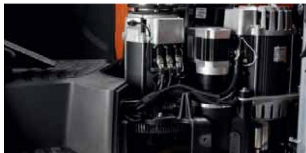
*AC-Motoren ohne Kohlebürsten senken den Wartungsaufwand*
