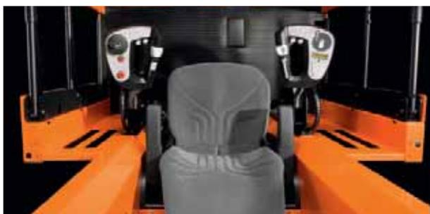
Die geteilte Bedienkonsole erlaubt bei der Kommissionierung einen einfachen Zugang zu den Gabeln
