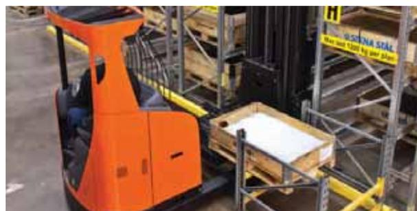
*Die Ausführung VRE125SF mit Teleskopgabeln ist auf möglichst geringe Gangbreiten optimiert*
