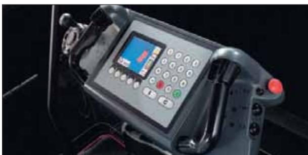
*Über die integrierte Bedienkonsole der A-Serie lassen sich alle Staplerfunktionen elektronisch bedienen*
