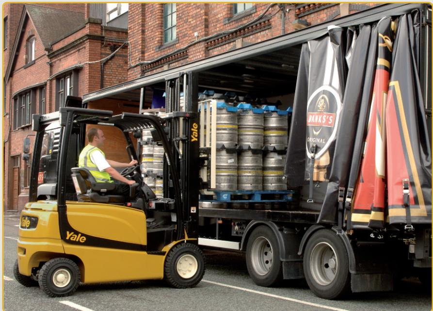
Vorlieben des Fahrers gerecht zu werden. Für maximale Geschwindigkeit und Beschleunigung wird Modus 4 gewählt, wohingegen Modus 1 ein sensibleres Lenken erlaubt und die Batteriestandzeit verlängert.
