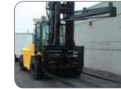
Zinkenverstellgerät mit Seitenschub für Gipsbauplatten
