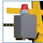
2. Eine speicherprogrammierbare Steuerung (SPS) auf dem Rahmen erfasst Daten von den Sensoren, errechnet die korrekte Klammerkraft und sendet die entsprechenden Befehle an das Proportionalventil.
