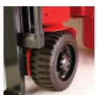
Vier große Hochelastikreifen sorgen für optimale Fahrleistung und Zugkraft auf dem Werksgelände. Und dank ihrer Widerstandsfähigkeit sind eine lange Nutzungsdauer und weniger Ausfälle garantiert.
