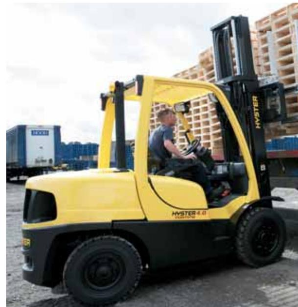
Oben: Der HSM™ (Hyster Stability Mechanism) vermindert die Seitenneigung von Staplern bei Kurvenfahrt und verbessert so die Seitenstabilität. Die Ausführung gewährleistet ein sichereres Fahren bei unebenen Bodenverhältnissen.
