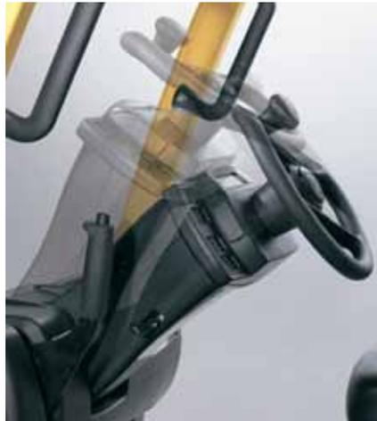
Links: Das standardmäßige Lenkrad mit einem Durchmesser von 30 cm und einem Lenkradknopf verfügt über eine in der Neigung frei einstellbare Lenksäule.
